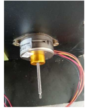
d. Imagine actuator liniar montat in ansamblul experimental
