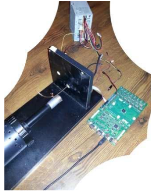
b. Etapa programarii microcontoller-ului care comanda miscarea actuatorului
